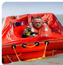
La balise GlobalFix V5 peut être déployée dans un radeau de survie. Il faut qu'elle soit tenue en position verticale, et dégagée par rapport au ciel, de préférence hors de la capote de protection du radeau. La balise peut également être attachée au radeau de sauvetage pour pouvoir flotter à proximité.
