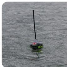
Si le navire risque de couler, la GlobalFix V5 doit être retirée de son support, l'antenne déployée et ensuite être immergée. Au contact de l'eau est automatiquement activée.
