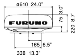
Capteur radar radôme 24" DRS4D-NXT 7.3kg 16.1 lb
