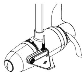
**⚠ AVERTISSEMENT :** Lors de l'installation de la sonde, assurez-vous que la boucle du câble est suffisamment lâche pour que l'arbre du moteur puisse pivoter librement sans endommager le câble.
