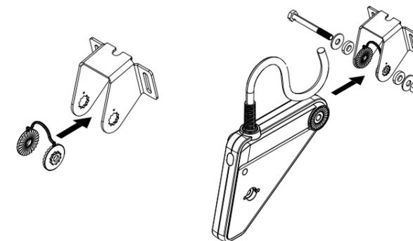
Serrez pour que les rondelles en caoutchouc s'élargissent jusqu'au diamètre des rondelles métalliques. Ne serrez pas trop.
